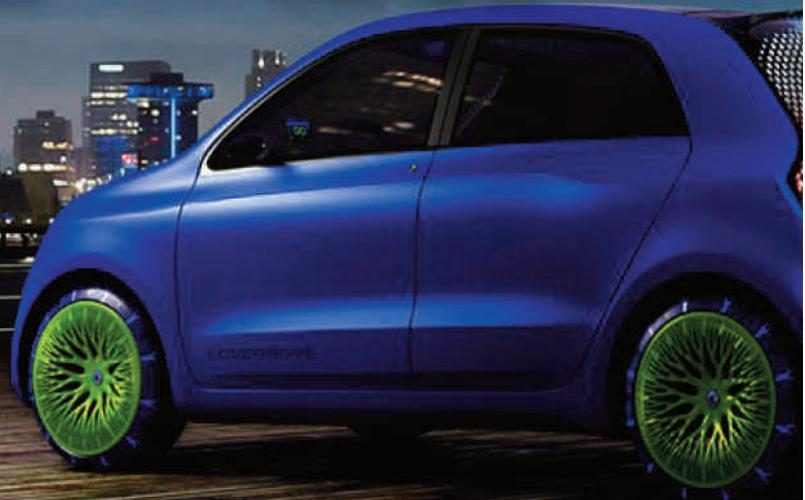
für die Klasse der kompakten City-Cars schuf. Markante Merkmale des nur 3,62 Meter langen Twin'Z sind die hohe Gürtellinie und die großformatigen, weit in die Ecken gerückten 18-Zoll-Räder. Diese Auslegung ermöglicht nicht nur agile Fahreigenschaften, sondern auch den großzügig bemessenen Innenraum. Gleichzeitig signalisiert die straffe Formgebung Kraft und Sicherheit.
