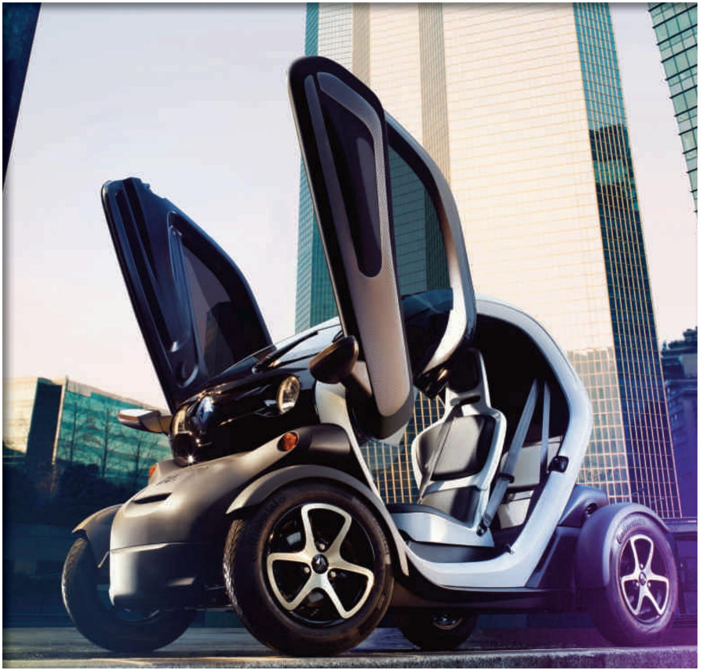
Dank seines niedrigen Gewichts von 450 Kilogramm – inklusive der 100 Kilogramm schweren, wartungsfreien Lithium-Ionen-Batterie – erreicht der Twizy darüber hinaus eine praxisgerechte Reichweite von 100 Kilometern nach innerstädtischem Zyklus ECE-15 .1. Der Twizy ist in zwei Leistungsstufen mit 4 kW/5 PS oder 13 kW/18 PS erhältlich.
