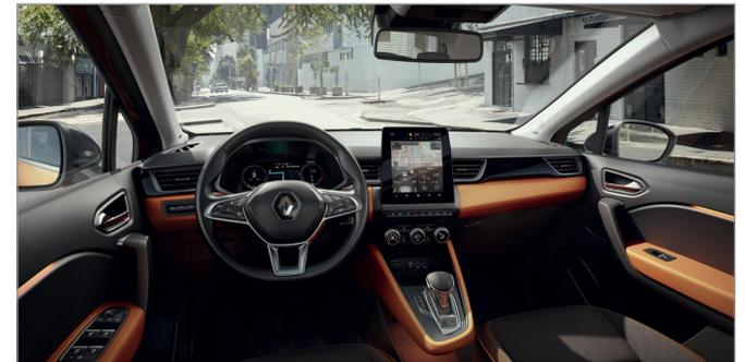
Das fahrerorientierte „Smart Cockpit“ ist das bestimmende Kennzeichen im Innenraum des neuen Captur. Anders als beim Vorgänger ist die Mittelkonsole mit dem Multimediainstrumentor leicht dem Fahrer zugewandt.
