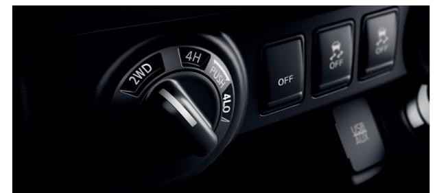
Der ZUSCHALTBARE ALLRADANTRIEB ermöglicht ein breites Einsatzspektrum auf und abseits asphaltierter Straßen. Gewechselt werden die drei Fahrstufen mit einem Drehregler an der Mittelkonsole. Der Fahrer kann zwischen Hinterradantrieb (2WD) und starrem Allradmodus für leichtes Gelände (4H) wählen. Für anspruchsvolle Offroad-Etappen lässt sich zusätzlich die Geländeunterstützung aktivieren (4LO).
