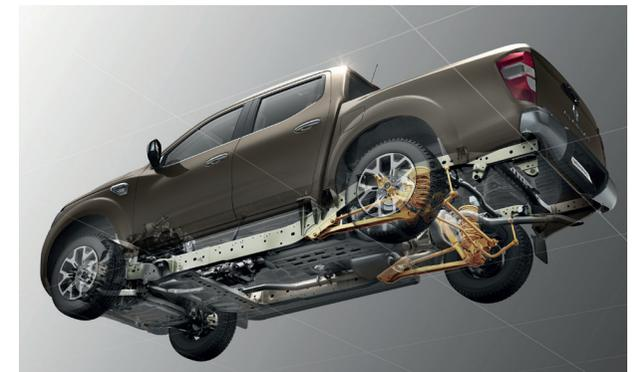
Die MEHRLINKER-HINTERRADAUFHÄNGUNG mit Schraubenfedern ermöglicht eine präzise Radführung. Ergebnis ist ein hoher Fahrkomfort. Als weiterer Vorteil verringern sich Fahrwerksgeräusche und Vibrationen.
