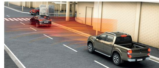
Der NOTBREMSASSISTENT warnt bei Gefahr einer Kollision mit dem Vordermann akustisch und mit einem optischen Signal im Kombiinstrument. Bremsen der Fahrer nicht oder nicht ausreichend stark, löst das System eine Notbremsung aus, gegebenenfalls bis zum Stillstand.
