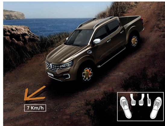
Der BERGABFAHRASSISTENT bremst den Alaskan in Bergabpassagen ab zehn Prozent Gefälle automatisch auf Schrittgeschwindigkeit (maximal 7 km/h). So kann sich der Fahrer auf das Lenken konzentrieren, ohne die Bremse oder das Gaspedal betätigen zu müssen.
