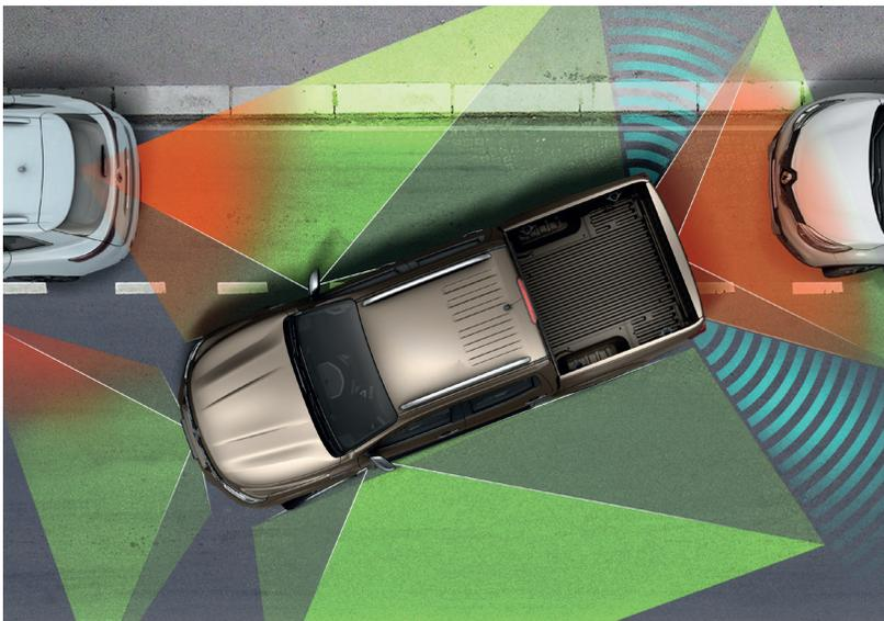
Der ARROUND VIEW MONITOR erleichtert das Einparken, Fahrten im Gelände und das Ankuppeln von Anhängern. Mit Hilfe von vier vernetzten Nahbereichskameras bildet er den Alaskan und seine Umgebung auf dem Display des Multimediasystems aus der Vogelperspektive, von vorne, von den Seiten und von hinten ab. Dadurch werden auch Hindernisse sichtbar, die sich unterhalb der Fensterlinie oder hinter dem Fahrzeug befinden.
